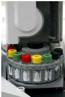
Les échantillonneurs automatiques extrayant l'échantillon du flacon avec une seringue nécessitent une seringue rincée après chaque injection pour ainsi minimiser le risque de polluer un autre échantillon. Due à la sensibilité croissante des analyses, cette phase de rinçage devient incontestablement plus importante, surtout lorsque des échantillons très différents ou visqueux sont analysés. Les récipients dans lesquels se trouve le solvant pour le rinçage sont dénommés «flacons de rinçage».
