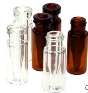
Le micro-flacon «iV2 $\mu$ -Vial», où l'insert porte la tête du flacon, est le dernier membre de la famille. Ainsi, l'insert est directement fermé et la vapeur de l'échantillon ne peut pas échapper dans la cavité entre le flacon proprement dit et l'insert. Le corps du flacon n'est rien d'autre qu'un tube de gaine qui est scellé à l'insert au fonds du flacon. Nous
