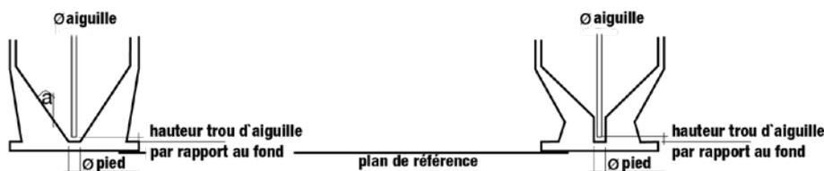
Le volume mort d'un flacon à pied conique forme un tronc de cône avec l'angle latéral  $a$ , tandis que le volume mort d'un flacon à pied cylindrique - comme de celui produit par la manufacture Gräfenroda S.à.r.l. (GTG) - forme un cylindre.
